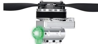
森飛25の推進システムであるブラシレスモーターは、信頼性と耐候性に優れた設計で、1個あたりの最大離陸重量が7~9.5kgまで耐えることができます。耐候性素材でベアリング、ESCなどをほこりや粉塵から回路基板を保護します。内部には冷却フィンを備え、過酷な環境下でも連続運転を可能にします。プロペラは最高の強度と剛性を実現するために高度な複合材である34inchのウルトラカーボンを使用し、空力効率や長時間飛行を可能にしました。
