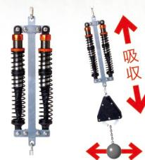
吊り下げ式はドローン本体に運搬物を固定させる必要が無いため作業効率は高いですが、加速やブレーキ、環境による重心移動で機体が安定せず、ハンチング(上下運動が収まらない)状態に陥ります。そこで安全な作業を実現するために共振防止装置を開発しました。これは運搬物の重心が上下左右にずれた時、この共振防止装置が衝撃を吸収して運搬物の揺れを止めることができます。本機構は(株)マゼックスが特許取得済みです。
